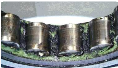
Деградация смазки по причине токов электрического разряда
